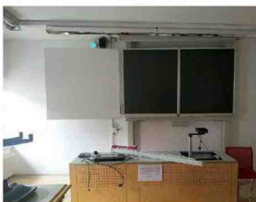
L'IMPIEGO di un sistema di allerta semaforico (luce verde in alto a sinistra) per l'apertura manuale dei serramenti ha restituito buoni livelli di IAQ per brevi periodi
